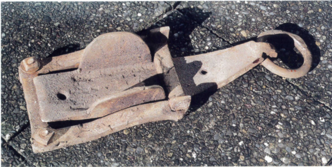
Radschuh mit unterlegtem Kretzer
