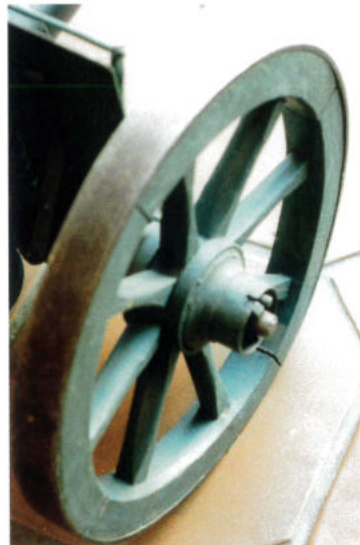
Die Radnabe wird vom Schmierring durch den «Lung» an der Achse fixiert.
