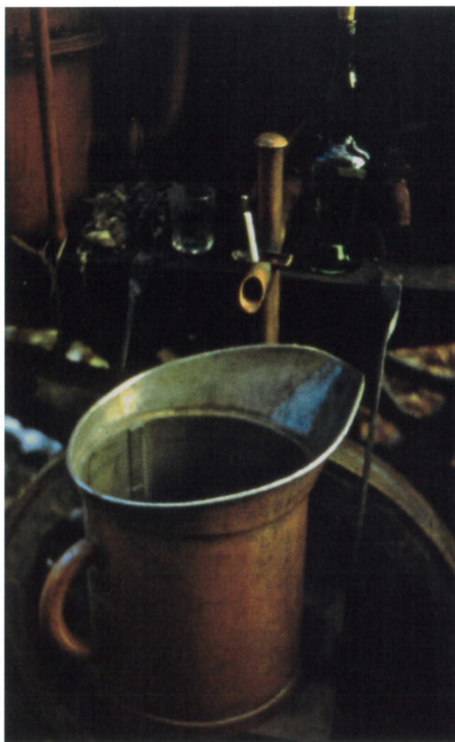
Der schwere, verzinkte Kupferhafen wartet auf den «Vorlauf».
