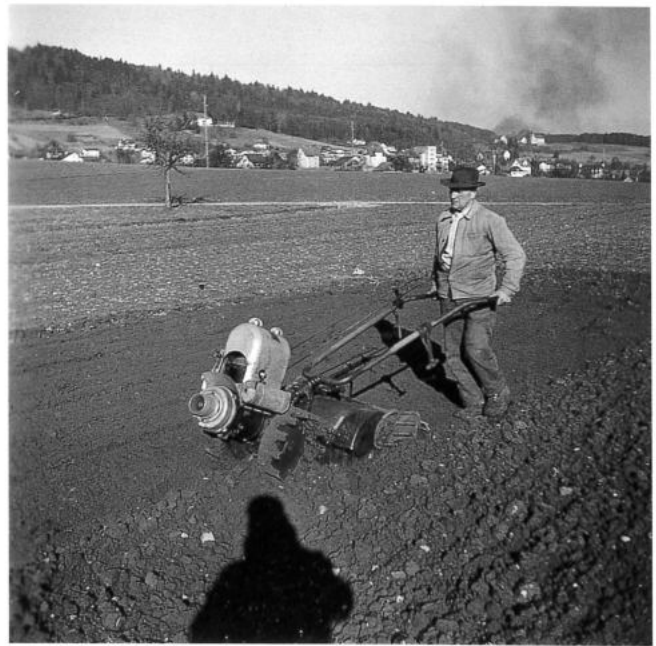
1936 kaufte der Vater für die Bearbeitung des Bodens für Gemüsekulturen eine Grunder-«Bodenfräse». Er sagte immer wieder, dass dies die beste Investition für eine gefreute Arbeit auf einem wohlvorbereiteten feinkrümeligen Pflanzbeet war.
